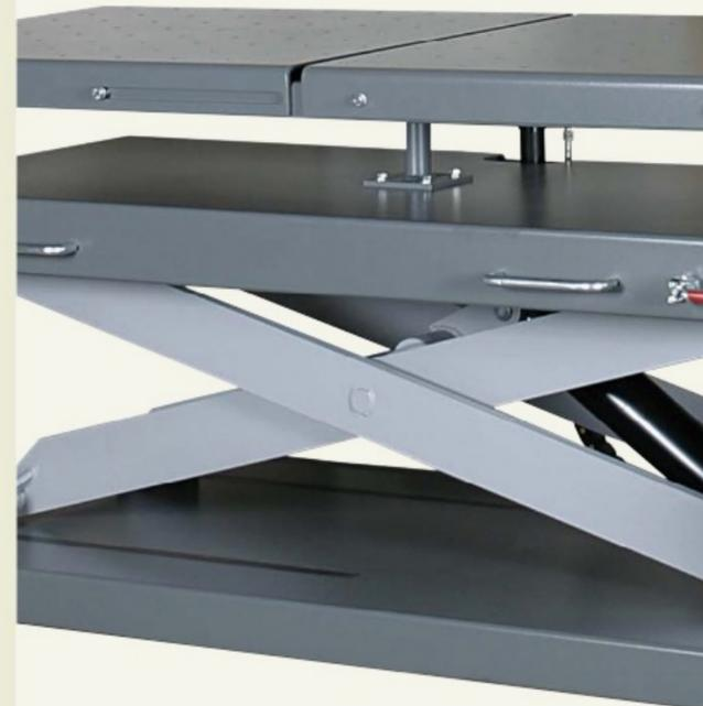
Mit dem Scherenhubtisch VAS 6131B lassen sich Motoren und Getriebe der modernen Aggregategeneration ohne zusätzliche Vorrichtung als Einheit schnell ein- und ausbauen. Diese Antriebsstränge haben ein Gewicht von bis zu 800 kg, weshalb der herkömmliche Motor- und Getriebeheber hier nicht verwendet werden kann. Bedienkomfort und einfache Manövrierfähigkeit setzen Maßstäbe und machen das Produkt unverzichtbar.
