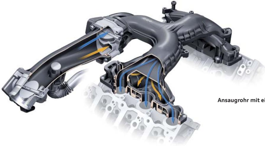
Ansaugrohr mit einer Drallklappe
