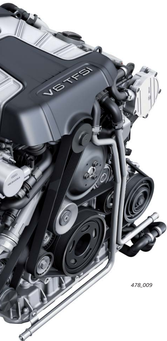
Angepasster Riementrieb (Entfall der Lenkhilfpumpe)
