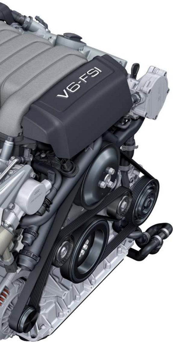
Angepasster Riementrieb (Entfall der Lenkhilfpumpe)
