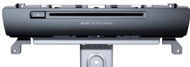
Vorderseite J794 bei MMI Radio
