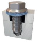
Für den Einsatz bei Langlöchern oder auf weichen Materialien wie Aluminium, empfehlen wir die Verwendung von Nord-Lock Keilsicherungsscheiben mit vergrößertem Außendurchmesser (sp).
