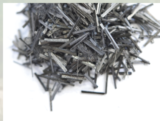
Für Karbon-Keramik-Bremsscheiben verwendete Werkstoffe: Siliciumcarbid und Carbonfasern
